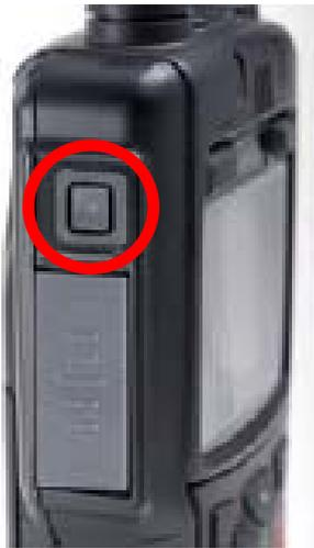
Durch das drücken der Side-Key Taste kann, innerhalb der Betriebsart, zwischen der aktuellen und der zuletzt verwendeten Rufgruppe gewechselt werden.
