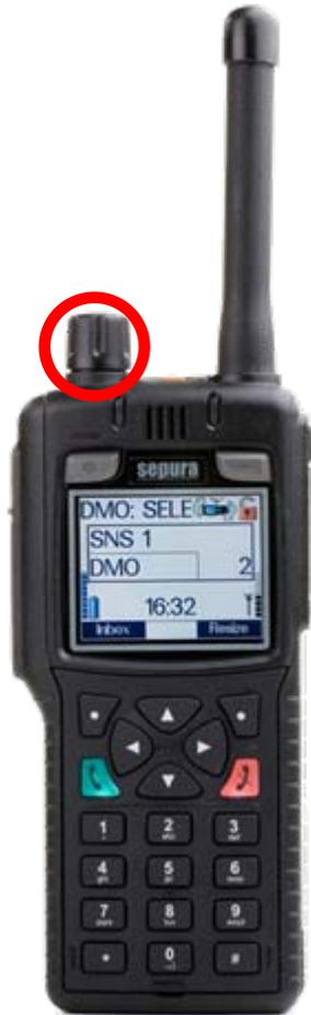
Mit dem durchgängig drehbarem Drehknopf
